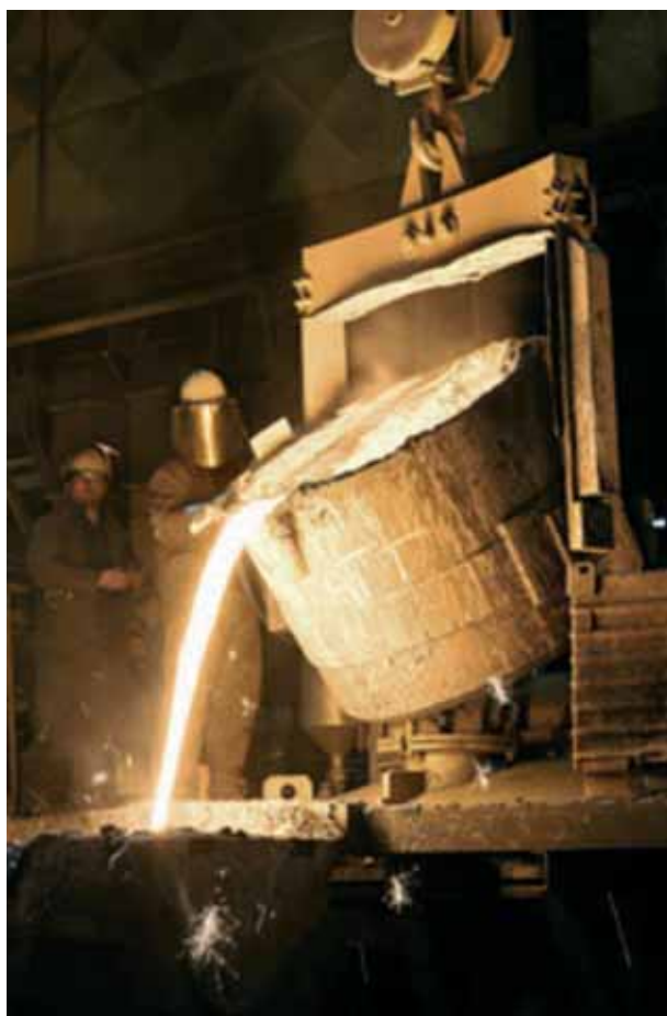
Abb. 1 1800 Grad heiß ist das flüssige Eisen, aus dem in Brühl Motorblöcke geformt werden
